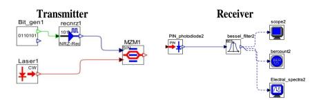
Fig. 6. NRZ Modulation format.
